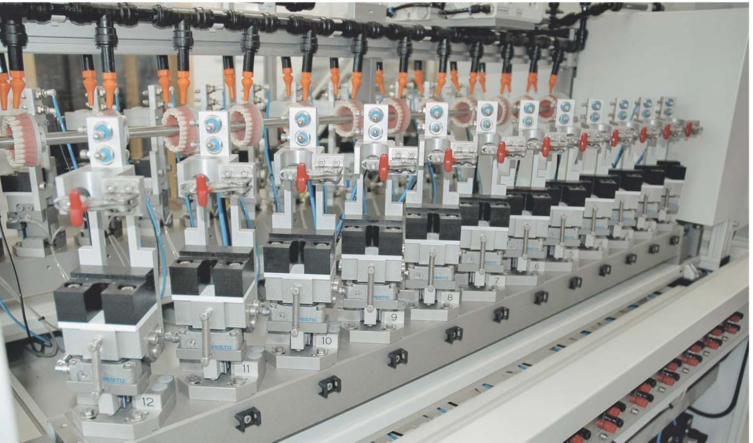
Mittels künstlicher Zahnreihen und Zahnpasta-Emulsion wird die normale Lebenserwartung einer elektrischen Zahnbürste innerhalb von etwa einhundert Stunden durchlaufen.
