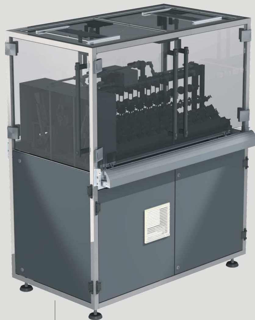
Prüfstand für elektrische Zahnbürsten
