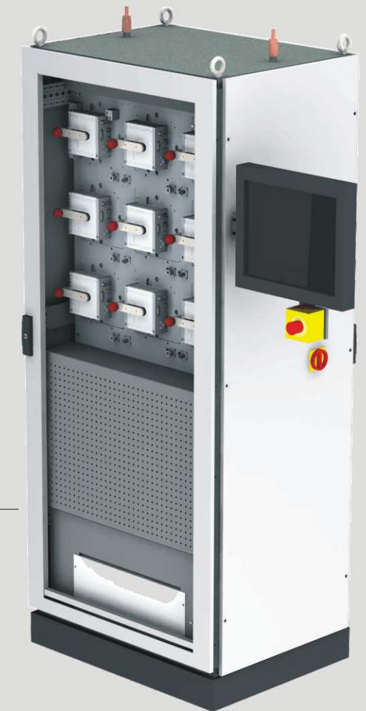
Dauerprüfstand für Pumpenregler
